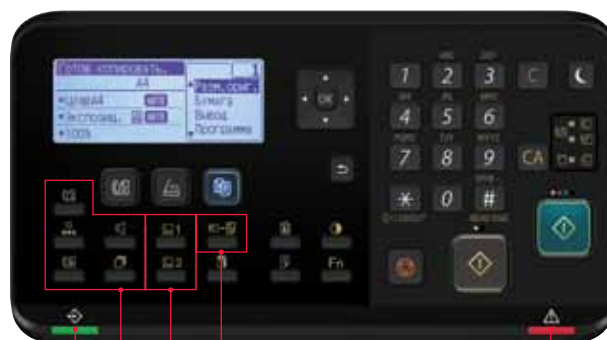
Зеленый LED индикатор данных Клавиши функций факса Программируемая клавиша сканирования Копирование ID-карты Красный LED индикатор ошибки
